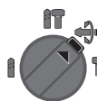
Позиция Vario-Lock за фиксиране на позицията за къртенето Превключвателят ударно пробиване/спиране на въртенето 13 не се фиксира в тази позиция.
